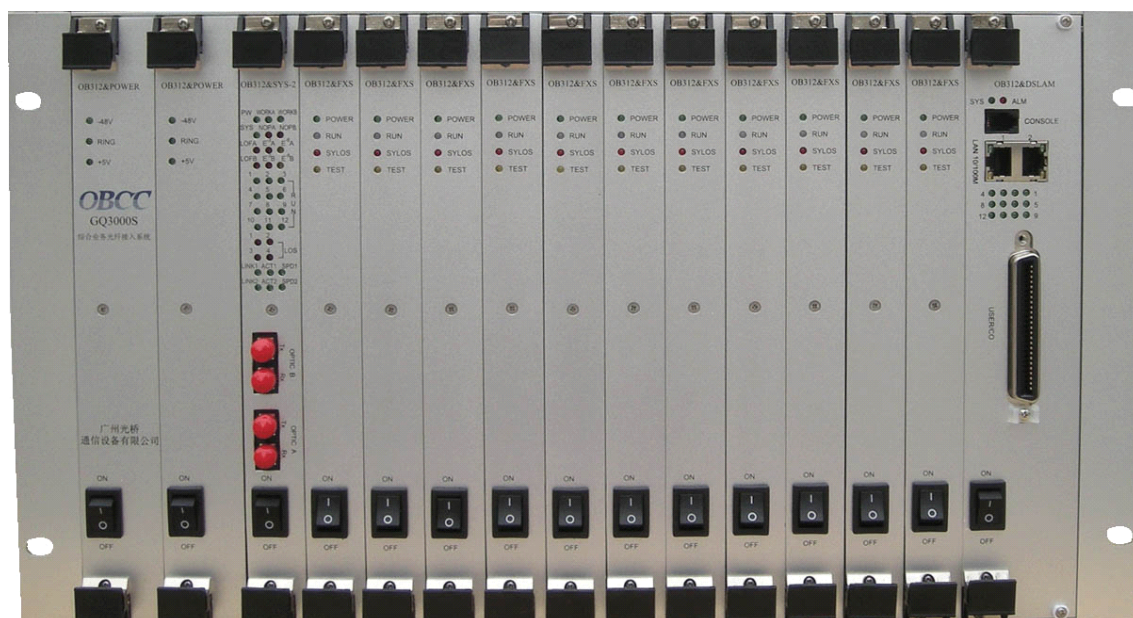
图 1.3 GQ3000S 综合业务光纤接入系统正面图
