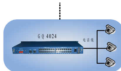
点对多点电话 PCM 传输组网方案
